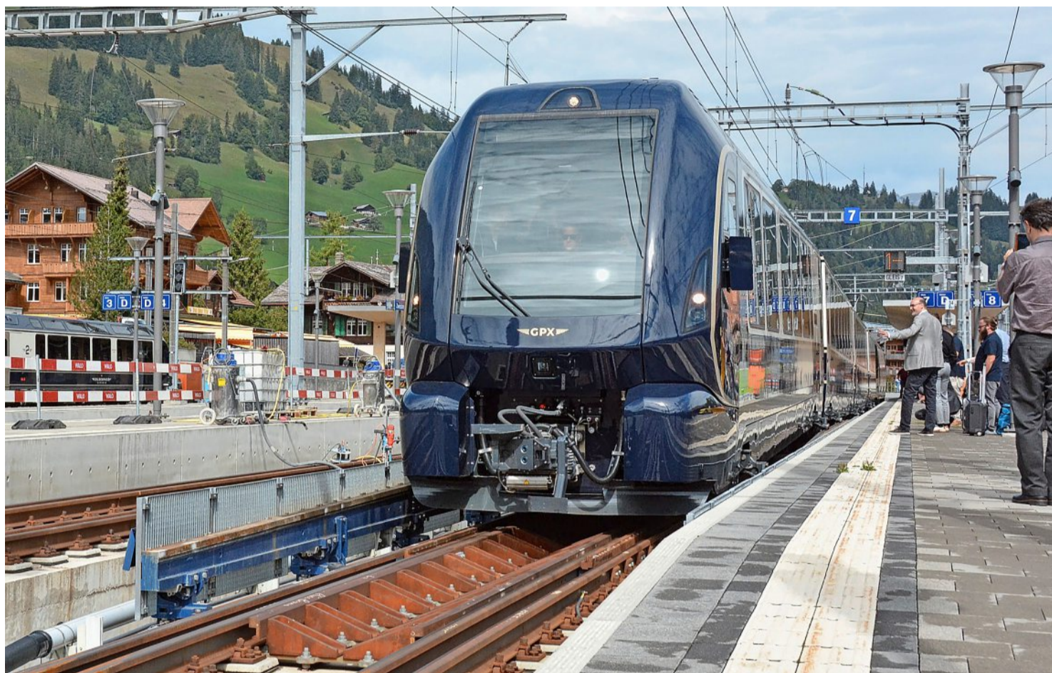
Der Goldenpass-Express wird in Zweisimmen vom Normalspurgleis der BLS auf das MOB-Schmalspurgleis umgespurt. Foto: Guido Lauper
